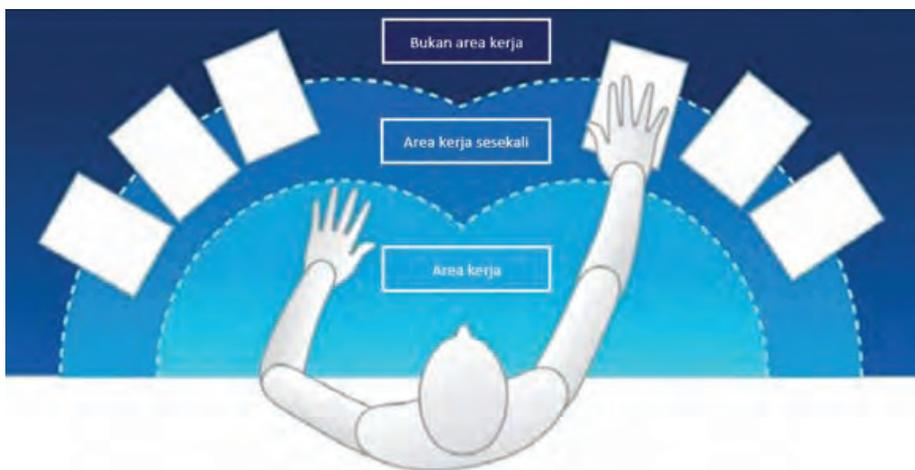
Gambar 2. Peletakan barang berdasarkan jangkauan tangan pada meja kerja<sup>23</sup>
